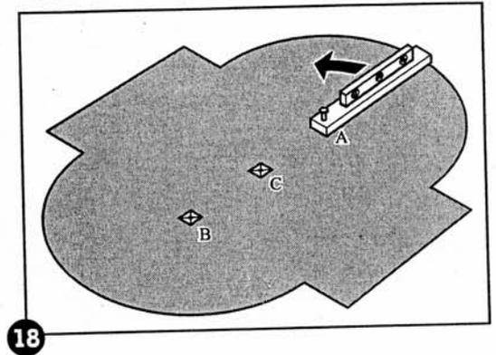
д. Удалите с площадки все выступы при помощи совковой лопаты, грабель или скрепка. На случай удаления большого количества земли рекомендуется иметь в запасе или предусмотреть возможность проката землеройного инструмента. Помните, что уровень бассейна должен быть выставлен с точностью до 1" (25 мм) по всей длине бассейна. При необходимости, установите высоту бруска и продолжайте устранять землю пока поверхность не станет ровной.
