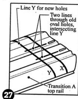
д. Если для вашего бассейна требуется дополнительная крепежка, просверлите дополнительное отверстие размером 1/4" (6 мм), 1-1/2" (38 мм) или 2-1/8" (54 мм) на линии **Y**. Примените эту дистанцию на вашем бассейне.
