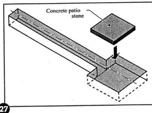
н. Поверх слоя известняка в каждую лунку положите бетонный камень толщиной 12"x12" мм<sup>2</sup> x2" (30x30x5 см). Проверьте, чтобы камень был ровно и правильно расположен в лунке.
