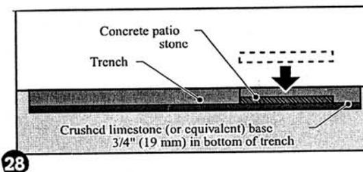
о. Заполните лунки толченым известняком (или заменителем). Заполните лунки известняком до верхних краев камней. Если известняк сухой смочите его немного водой для того, чтобы он лучше утрамбовался в лунке. Оказывая давление на камень (давление необходимо чтобы камень не сдвигался в лунке) утрамбовывайте известняк, пока основание не станет твердым. При необходимости добавьте еще известняка. Не трамбуйте известняк слишком сильно, так как камень может сдвинуться в лунке.
