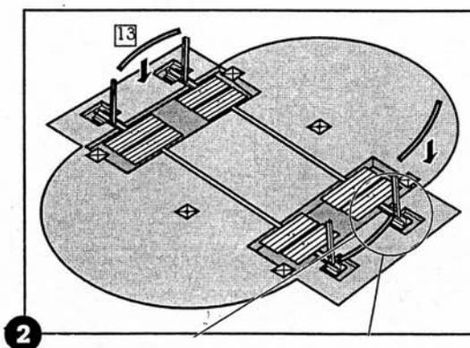
г. Установите **переходные поручни А** (№13). Вставьте один конец каждого поручня в выемки в стойках (см. рис. 5 и 6) а другой конец в паз крепежи основания (№14) (см. рис. 9, 10 и 11).
