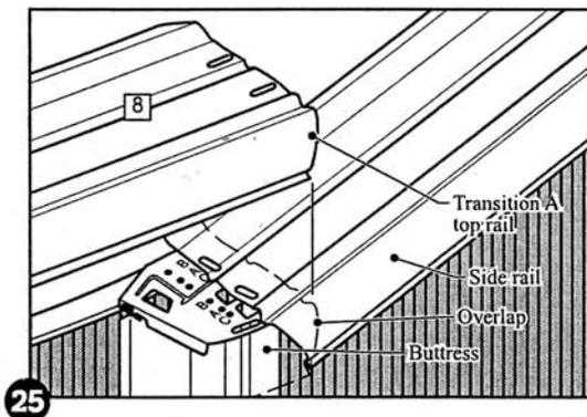
в. На конце бокового поручня расположенного **сверху** переходного поручня отметьте две длины 1/2" (13 мм) и 1.1/8" (29 мм) от края конца поручня. Затем
