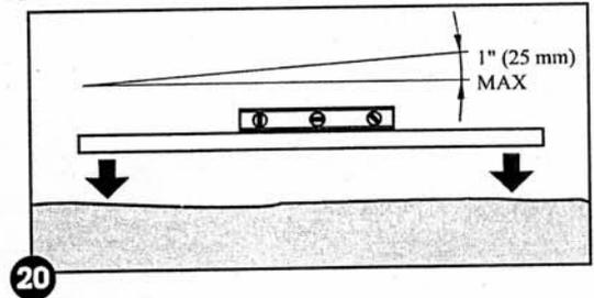
е. Не подсыпайте для выравнивания свежий грунт. Это ослабляет безопасность фундамента бассейна. Допускается заполнение небольших ямок и впадин, но после этого земля должна быть сильно утрамбована при помощи инструмента для утрамбовки.
